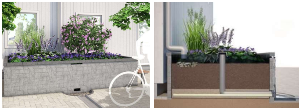
Figur 6.2 a) & b). Exempel på upphöjd växtbädd som tar emot dagvatten från tak via stuprör (Vinnova, 2014).
