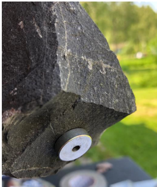
Bilden visar sulfidförande bergkrossmaterial från Kalvö industriområde.
