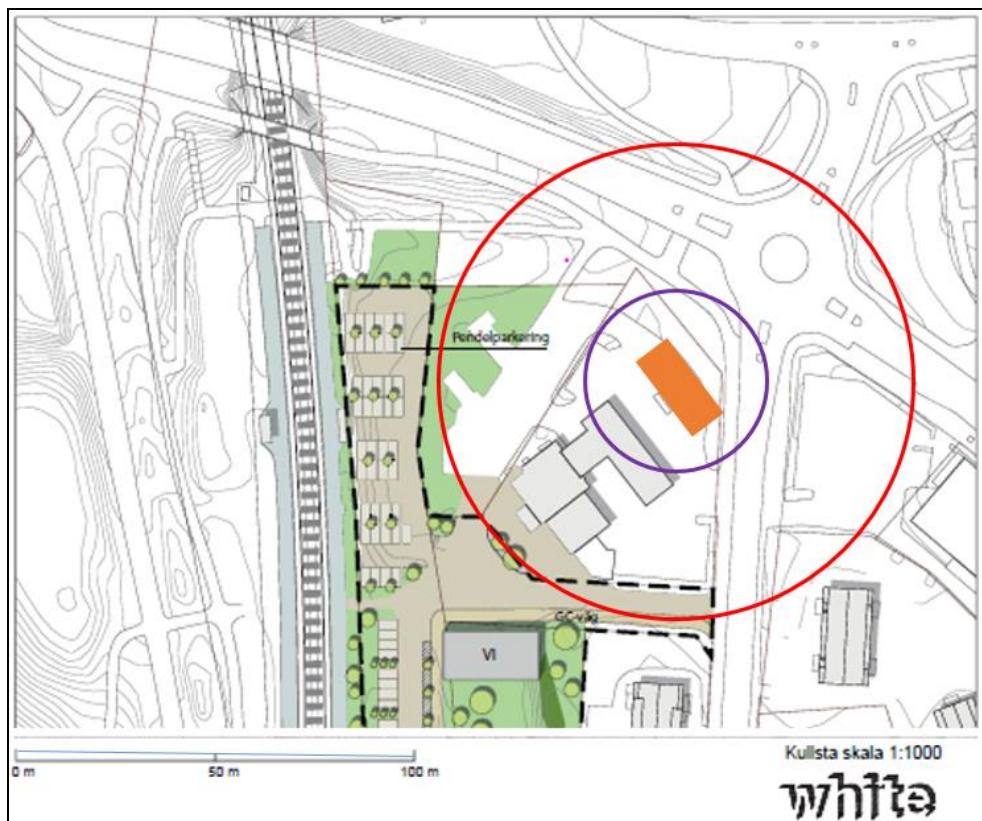
Figur 10. Pölbrand med yta på 200 m 2 . Avstånd till 2,5 kW/m 2 (smärta efter 20 s) anges med röd ring, avstånd till 15 kW/m 2 (antändning av trä och plast) med lila ring.
