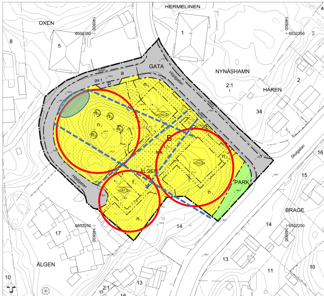
Figur 2: Planvy med höjdkurvor. Aktuellt projektområde (fastighet) är gulmarkerat. De tre bergkullarna är markerade med röda ringar. Blå streckade linjer illustrerar ungefärligt läge på svackor i terrängen. Blåmarkerat parti, i nordvästra delen av området, utgörs av en mer vittrad/omvandlad bergmassa
