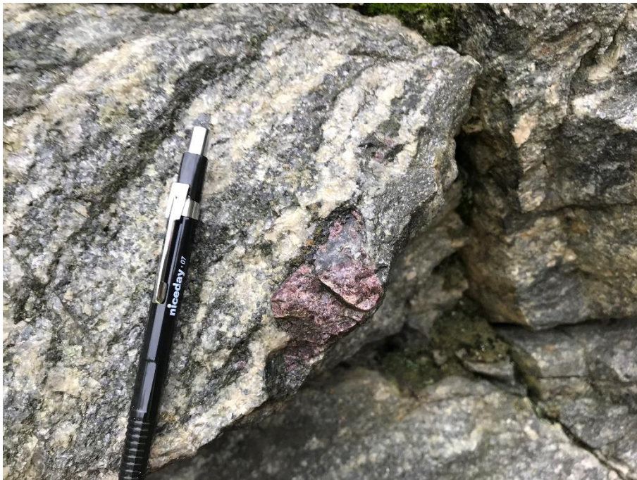
Figur 4: Huvudsaklig medelkornig, förskiffrad sedimentådergnejs. Foto på lokal vid västra området av fastigheten.
