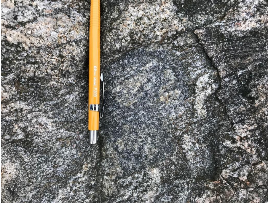
Figur 4: Huvudsaklig medelkornig, förskiffrad sedimentådergnejs. Foto på lokal vid västra området av fastigheten.
