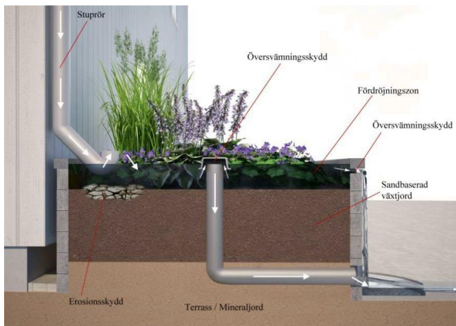
Figur 16 Principskiss för biofilter med upphöjd konstruktion. (Bildkälla: Grågröna systemlösningar för hållbara städer, Inventering av dagvattenlösningar för urbana miljöer, Vinnova 2014.)
