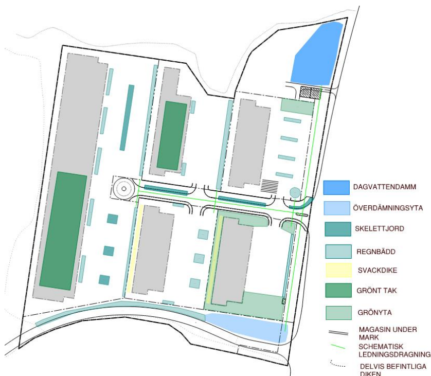
Figur 5-1. Systemlösning för dagvattenhantering med ungefärligt ytbehov för olika typer av dagvattenanläggningar som illustreras för fyra av fem fastigheter. Detta är endast exempel på möjliga lösningar. Utformning av kvartersmark sker i senare skede.
