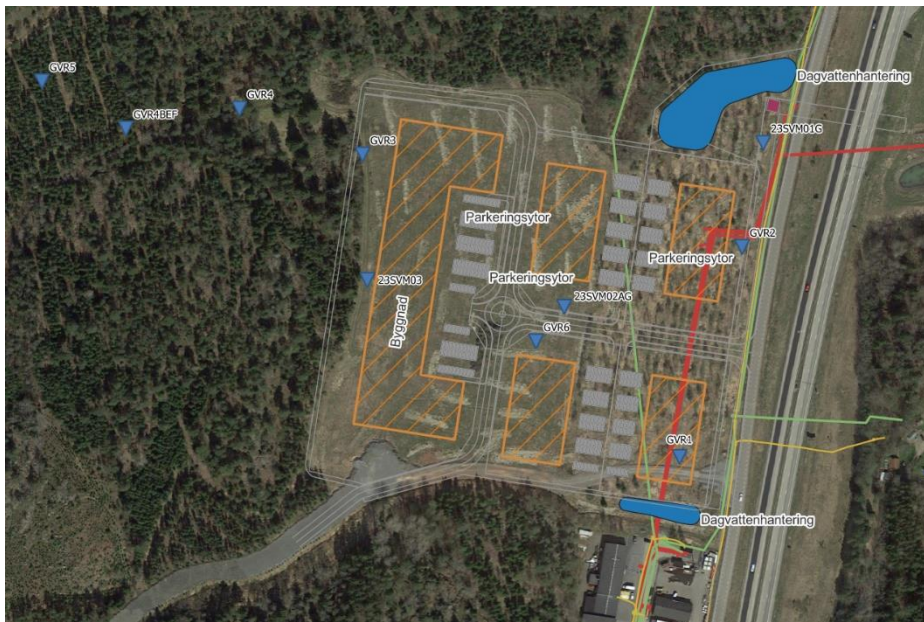
Figur 2-10. Placeringen av grundvattenrör inom planområdet samt nordväst om utredningsområdet. Huskroppar, parkeringar och dagvattenanläggning är endast en schematisk redovisning av hur planområdet kan utformas. GVR6 erhöll inga mätresultat.
